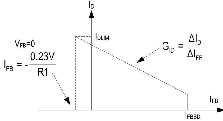
从上图可以看出， $I_{FB}$  电流大， $I_D$  的电流就小； $I_{FB}$  电流小， $I_D$  的电流就大。当  $I_{FB}$  的电流大于  $I_{FBSD}$  时，芯片会关闭 PWM，此时的  $I_D$  的值大约为 85mA，同时芯片会自动进入突发模式。这对于系统工作在空载或者轻载至关重要。
