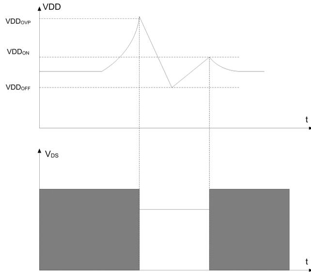
当芯片 VDD 的电压超过  $VDD_{OVP}$  时，会触发内部复位信号，导致系统重新启动。
