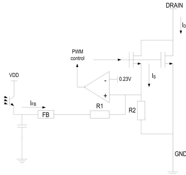
通过高压 MOS 的电流  $I_D$  分成两个部分，其中一部分为  $I_S$ ，这部分电流为芯片采样电流。 $I_S$  与  $I_D$  成比例关系：
